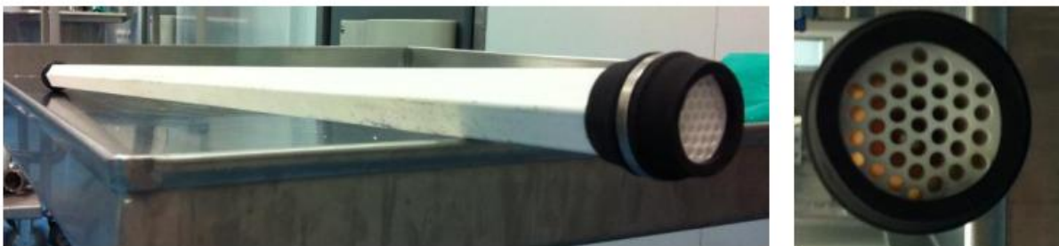
Figure 3. Membrane de MF 1,4 \mu\text{m} en céramique
