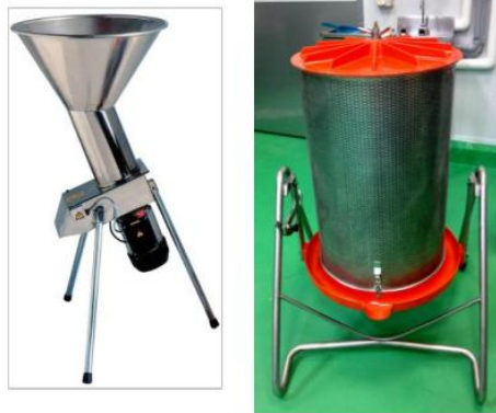
Figure 1. Broyeur à fruits et presse à jus utilisés lors de l'élaboration du jus de concombres
