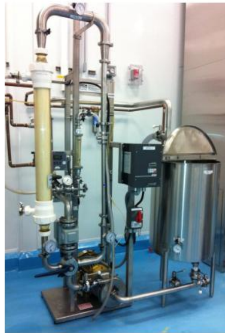
Figure 5. Système d'UF et membrane de 10 kDa
